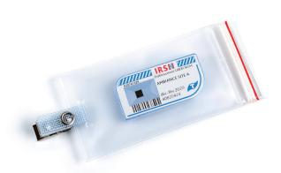
Le dosimètre d'ambiance avec sa pochette de protection pour usage exterieur. Le laboratoire de dosimétrie de l'IRSN est accrédité par le Comité Français d'Accréditation (COFRAC 3) pour réaliser les mesures en équivalent de dose ambiant H\*(10) selon les exigences de la norme ISO 17025.
